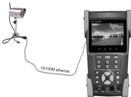
Рис 3.2.1-1. Подключение тестера к IP-камере.
