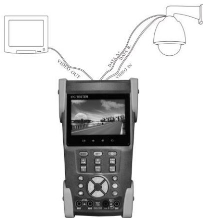
Рис 3.2.2-1 Подключение тестера к аналоговой камере.
